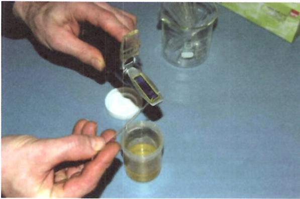
Mit dem Spatel oder Löffel wird eine kleine Menge des Honigs entnommen und auf das Glasprisma des Refraktometers getropft.
